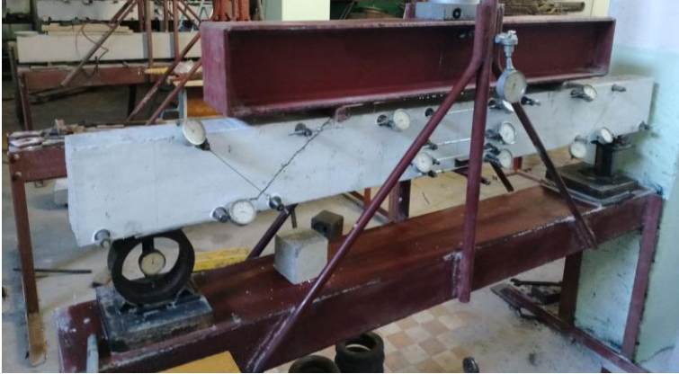
Рис. 2. Силова установка та розташування вимірювальних приладів
